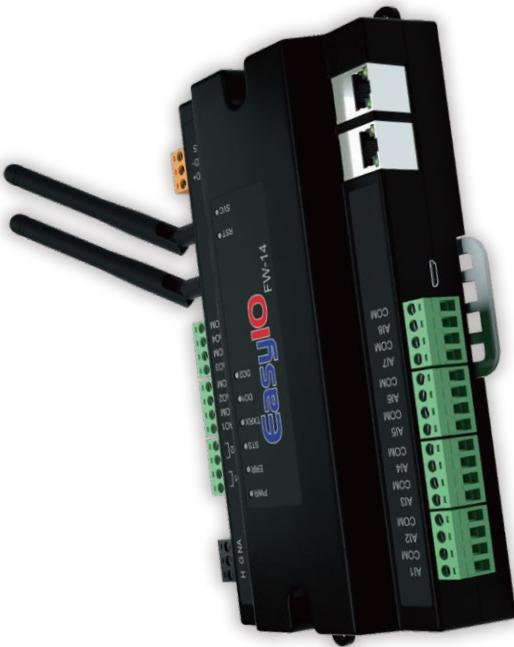
FW (Wi-Fi) 系列控制器支持IT网络和安全标准及Wi-Fi b/g/n协议。该系列控制器可以作为现有网络的一部分或作为独立的BMS Wi-Fi网络使用。借助双以太网端口，其可以在建议的IT标准范围内实现菊花链功能。
